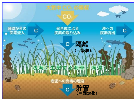
図-1 BC生態系によるCO 2 吸収の仕組み 1)
