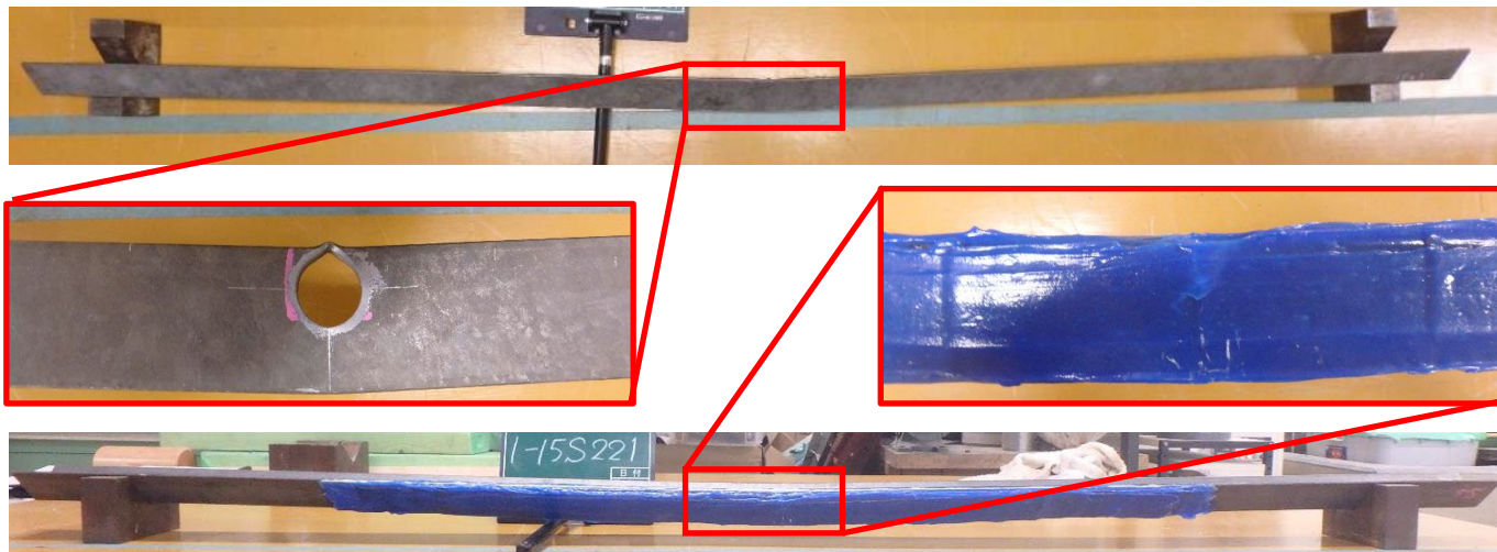
図-6 補修前（L45D2：上）補修後（L45D2R：下）の破壊形態
