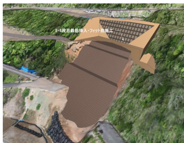
図-8 3次元BIM/CIMモデル（詳細度:300）
