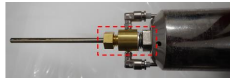
写真 2-1 改良された CS のノズル部分
