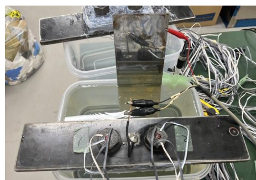
写真2 電気化学的腐食促進試験
